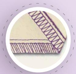
**5-Faden Sicherheitsnaht 12 mm**
