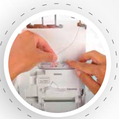
**ExtraordinAir™ Threading System:** Durch Drücken des Knopfes wird der Greifer mithilfe von Luft automatisch eingefädelt.
