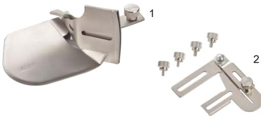
Mit dem Einfachfalten-Bandefasser lassen sich Stoffkanten und Halsausschnitte perfekt mit Band einfassen. Das ungefaltete Band wird durch die angebrachte Führungsschiene eingeführt, auf der oberen Seite umgeschlagen während die Unterseite offen bleibt und mit einem Coverstich versäubert wird. Für den perfekten Look kann das Band auch selbst angefertigt werden.
