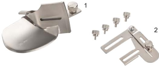
Mit dem Doppelfalten-Bandefasser lassen sich Stoffkanten und Halsausschnitte perfekt mit Band einfassen. Das ungefaltete Band wird durch die angebrachte Führungsschiene eingeführt, auf der oberen und unteren Seite des Schrägbandes doppelt umgeschlagen und mit einem Cover- oder Kettenstich angenäht. Für den perfekten Look kann das Band auch selbst angefertigt werden.
