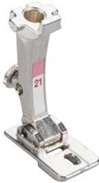
Mit ihm werden schmale Bänder und Kordeln beim Aufnähen exakt geführt. Durch das abgeschrägte Loch am Nähfuss passen bis zu 3 mm dicke Kordeln und schmale Bänder, die mit einem Nutz- oder einem Dekorstich aufgenäht werden können.
