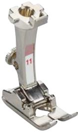
Dieser Nähfuss ist perfekt geeignet für das Nähen und Absteppen mit Cordonnet als Oberfaden sowie für das Sashiko-Musternähen und Ähnliches. Die 2 mm tiefe Rille auf der Fussunterseite sorgt dafür, dass das dickere Obergarn gut unter der Sohle transportiert wird.
