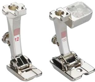
Zum Zusammennähen von Strickwaren, Aufnähen von dicken Kordeln, Perlenschnüren und Pailletten oder zum Herstellen und Einnähen von Paspeln im gleichen Arbeitsgang. Der Fuss #12C mit einer maximalen Stichbreite von 9 mm hat ein zusätzliches Führungsloch zum Übernähen von Beilaufgarnen wie Wolle, Garnen und Lederstreifen.
