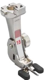
Mit diesem Nähfuss können Knöpfe und Haken angenäht werden. Die gummierte Sohle hält den Knopf beim Annähen sicher am gewünschten Platz fest. Über die Mittelzehe lässt sich die Höhe des Halses je nach Stoffdicke flexibel einstellen.
