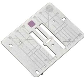
Diese Stichplatte hat eine violette Markierung und eine verkleinerte Stichlochbreite von 5,5 mm. Sie passt auf alle 9-mm-Maschinen und erzielt besonders gute Nähergebnisse beim Nähen von dünnen oder weichen Stoffen. Für detailreiche Näharbeiten können alle Zickzack- und Dekorstiche bis maximal 5,5 mm angewendet werden.
