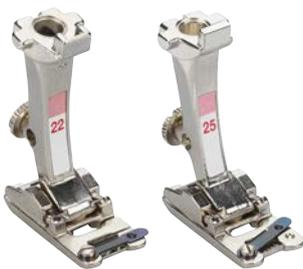
Die Rillen ermöglichen das gleichzeitige Aufnähen von nebeneinanderliegenden Garnen oder schmalen Bändchen, die durch die Lasche gerade gehalten werden. Dadurch ist ein Führen der Garne nicht nötig. Der Fuss #22 ist für drei und Fuss #25 für fünf nebeneinanderliegende Garne ausgelegt.
