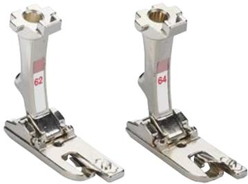
In Verwendung mit der Geradstichplatte bildet der Geradstichsäumer einen feinen Saum und sorgt für ein besonders schönes Stichergebnis. Der Stoff wird beim Nähen in einem Arbeitsgang doppelt umgeschlagen und mit einem Geradstich festgenäht. Die Füße #62 und #64 werden für Säume mit einer Breite von 2 bzw. 4 mm eingesetzt.
