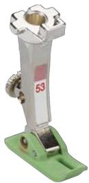
In Kombination mit der Geradstichplatte eignet sich dieser Nähfuss ausgezeichnet für alle Geradsticharbeiten und für schmale Nähte. Dank der Sohle mit Antihafbeschichtung bewegt er sich leicht über schlecht gleitende Stoffe wie Leder, Kunststoff oder ähnliche Materialien. Die beiden unterschiedlich breiten Fusszehen dienen zugleich als Führungslinien für Nahtzugaben von 3 und 6 mm.
