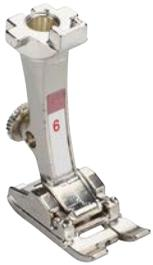
Der ideale Nähfuss für Raupennähte, Applikationen und Dekorstiche. Tolle Effekte werden durch das Übernähen von Dekorgarn erzielt. Das kleine Loch in der Mitte der Fussvorderseite dient dem Durchführen eines Beigarns oder Gummifadens. Es kann aber auch als optische Hilfslinie verwendet werden.
