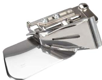
Der Bandenfasser fertigt mit nicht vorgefaltztem Schrägband in einer Breite von 28, 32 und 38 mm perfekte Kantenabschlüsse. Für den perfekten Look kann das Schrägband auch selbst angefertigt werden. Der Bandenfasser wird in Kombination mit dem Bandenfasserfuß #95/95C angewendet.
