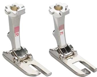
Mit ihm lassen sich exakte Kappnähte anfertigen. Da beide Nahtzugaben in die Saumnäht eingeschlossen und festgesteppert werden, eignen sie sich auch für beidseitig tragbare Bekleidung. Der Fuss #70 ist für Kappnähte bis 3 mm Breite und der Fuss #71 für Kappnähte bis 6 mm Breite geeignet.
