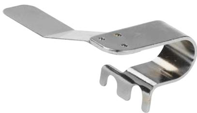
Die Führungslasche trennt die zwei Stofflagen. Die untere Lage wird gekräuselt, die obere bleibt glatt. Einfaches Kräuseln eines Stoffs ist ebenso möglich wie das Kräuseln und gleichzeitige Annähen an ein glattes Stoffteil.
