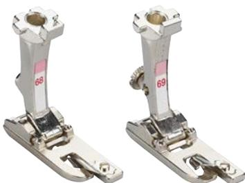
Dieser Nähfuss ist ideal zum Säumen von weichen Stoffen wie Tricot oder ähnlichen Materialien. Der Stoff wird beim Nähen in einem Arbeitsgang doppelt umgeschlagen und mit einem Overlockstich festgenäht. Dadurch bildet sich ein schmaler, leicht dreidimensionaler Saum, der nicht ausfranst. Die Füße #68 und #69 werden für Säume mit 2 bzw. 4 mm Breite angewendet.
