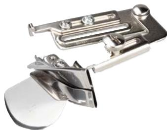
Der Bandenfasser dient zum Einfassen von Kanten mit vorgefaltztem Schrägband in einer Breite von 13, 20 oder 25 mm. Mit ihm gelangen perfekte Ecken und wunderschöne Rundungen, die mit einem Nutz- oder Dekorstich verarbeitet werden. Bänder von 13, 20 und 25 mm Breite ergeben eine fertige Breite von ca. 6, 9,5 und 12 mm. Der Bandenfasser wird in Kombination mit dem Bandenfasserfuß #95/95C angewendet.
