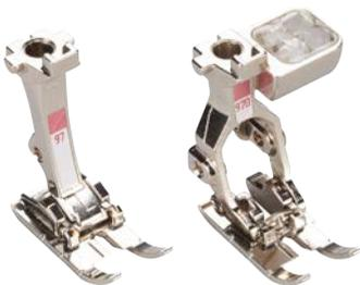
Mit dem Patchworkfuss gelingen die schönsten Quilts und exakte Arbeiten. Die Markierungen für Nahtzugaben mit 3 mm (1/8 inch), 6 mm (1/4 inch) und 7,5 mm auf der Fusssohle dienen zur genauen Orientierung. Ihre Auflagefläche eignet sich perfekt für Maschinen mit 9-mm-Stichbreite und ermöglicht eine sorgfältige Nähgut- und Stichführung beim Zusammenfügen von Stoffstücken.
