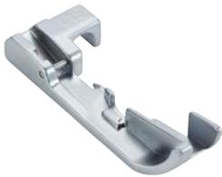
Mit dem Perlen- und Paillettenfuss können Perlen- und Paillettenschnüre von max. 6 mm Durchmesser schnell und einfach aufgenäht werden. Er wird für schöne Abschlüsse an Stoffkanten oder für Dekoration an Flachnähten verwendet. Die Rille an der Fussunterseite und der seitliche Führungskanal erfassen Perlen- und Paillettenschnüre optimal, sodass sie ohne Verrutschen vernäht werden können. In Kombination mit dem rechten Nahtführungslinial als Führungshilfe gelangen die Nähte besonders exakt.
