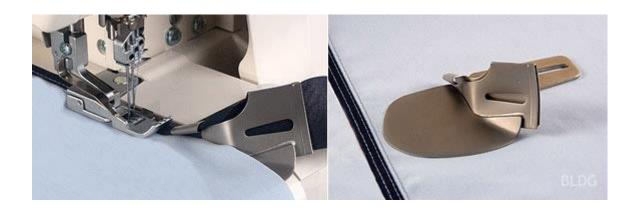
Der Einzelfaltschrägbinder macht es möglich, Stoffkanten oder Halsauschnitte mit Cover- oder Doppelkettstich sehr schnell und sehr exakt mit Schrägband einzufassen, wobei die Oberseite doppelt umgeschlagen wird und die Unterseite offen bleibt.
