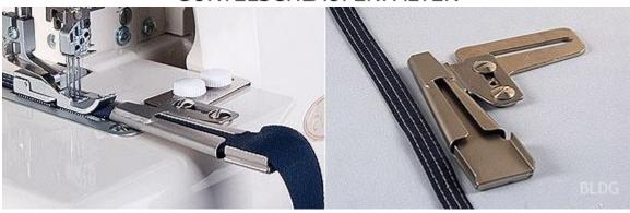
Ob Gürtelschlaufen oder Träger, dieses Accessoire fertigt Ihnen das perfekte Ergebnis mit dem Coverstich.
