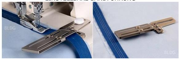
Zum geradlinigen Aufnähen von Bändern, Tressen und Litzen. verstellbar bis zu einer Breite von 60mm.
