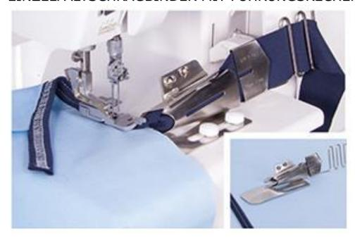
Der Einzelfaltschrägbinder ermöglicht ein professionelles Einfassen von offenen Stoffkanten (z. B. Halsausschnitte) mit Cover- oder Doppelkettstich. Schräg- bzw. Jerseystreifen werden durch die Faltvorrichtung so geführt, dass die Oberseite doppelt eingeschlagen wird. Die Unterseite liegt glatt und offen innen am Stoffrand.
