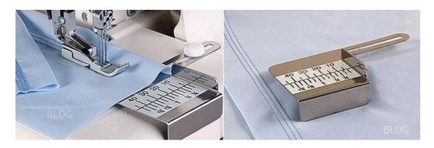
Diese Führung ermöglicht dank der verstellbaren Kante das präzise Anlegen der Säume/Umschläge und somit den korrekten Nahtabstand.
