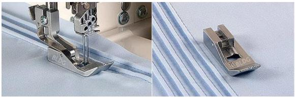
Mit dem Biesenfuß und der dazugehörigen Biesenzunge können Biesen und Fältchen einfach und perfekt mit dem Coverstich genäht werden. Der Einsatz der Kederführung ermöglicht das Einlaufen einer Kederschnur zur Stablilisierung und plastischen Darstellung der Biesen.
