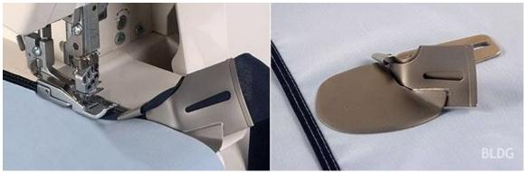
Der Doppelfaltschrägbinder macht es möglich, Stoffkanten oder Halsausschnitte mit Cover- oder Doppelkettstich sehr schnell und sehr exakt mit Schrägband einzufassen, wobei die Ober- und Unterseite des Schrägbandes doppelt umgeschlagen werden.
