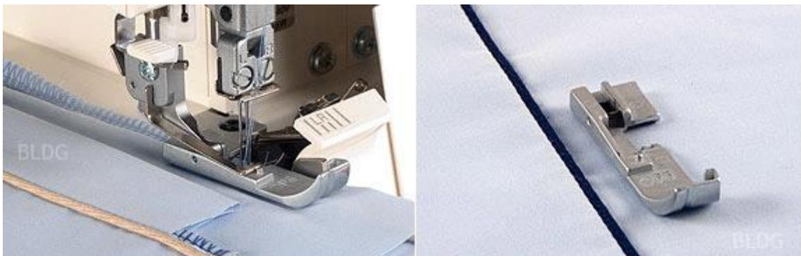
Dieser Fuß verfügt über eine speziell eingearbeitete Führungsnut auf der Fußunterseite. In dieser Nut wird das Paspelband oder der Keder exakt geführt. Man kann somit Paspelband professionell zwischen zwei Stofflagen einnähen oder eine Kederschnur einfassen.
