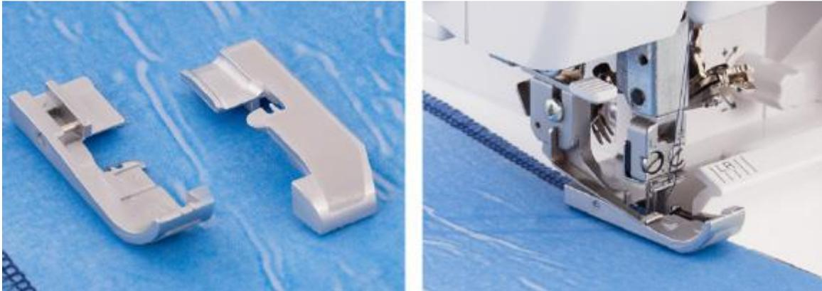
Dieser Fuß hat eine spezielle Beschichtung, damit Sie problemlos Wachstuch, Fleece-Stoffe oder Ähnliches nähen können. Auf Grund des starren Hinterteils des Fußes gleitet dieser besser über Quernähte und es gibt kein Aufstauen mehr.
